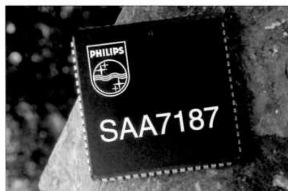
De SAA7187 zet digitale videobeelden om in PAL- of NTSC-signalen.
